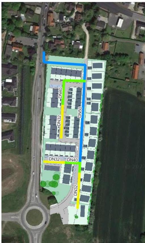
Figur 5-2 Oversigt over det nye ledningsnet
